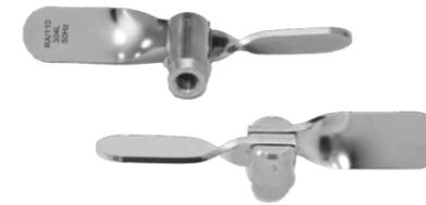
L'elica a pale oscillanti (standard) viene utilizzata principalmente per consentire l'installazione su contenitori chiusi e pieni. Viene inserita nel telaio del contenitore quando è piegata e si apre quando il dispositivo è acceso.
