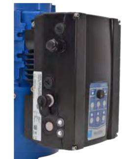
Convertitore di frequenza con velocità preimpostata da 750 a 1500 giri/min e bus di campo Modbus RTU integrato. Su richiesta sono possibili anche velocità inferiori. Disponibile nel formato A da 0,55 kW -1,5 kW e nel formato B da 2,2 kW-4,0 kW.
