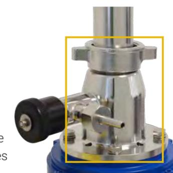
Un boîtier à bride spécial permet l'**injection directe** de dioxyde de soufre ( $\text{SO}_2$ ), de dioxyde de carbone ( $\text{CO}_2$ ) et d'autres gaz similaires lorsque l'arbre d'agitation est inversé. Ainsi, les gaz à ajouter au liquide sont mélangés intensivement dès leur arrivée.
