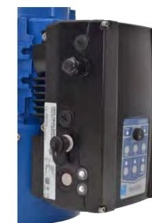
**Convertisseur de fréquence** avec vitesse pré-réglée de 750 à 1500 tr/min et bus de terrain Modbus RTU intégré. Des vitesses de rotation inférieures sont également possibles sur demande. Disponible dans les tailles de boîtier A de 0,55 k W – 1,5 kW et taille B de 2,2 k W – 4,0 kW.
